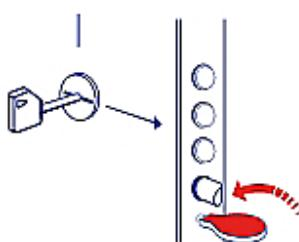
4. Повернути перекодувальний гвинт на  $90^\circ$  у горизонтальне положення. Замок вийшов з режиму перекодування.
