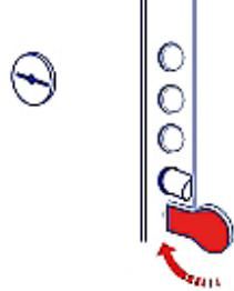
1. При закритих ригелях повернути перекодувальний гвинт на  $90^\circ$  у вертикальне положення. Замок перейшов у режим перекодування.
