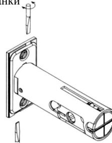
2. Зняти торцеву планку. Зняти пружину фіксації тильної частини торцевої планки.
